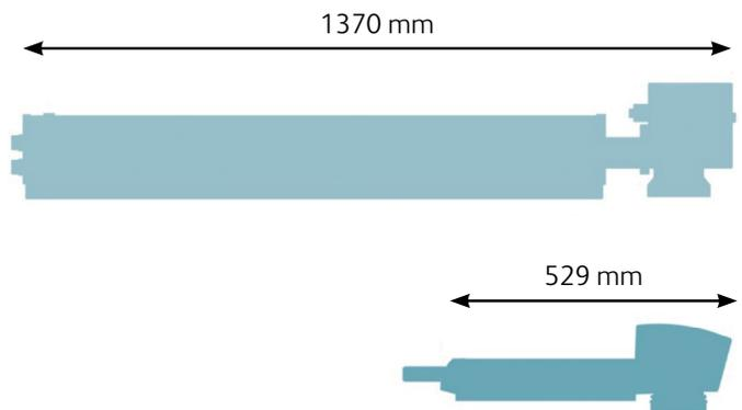
A comparação de tamanho é baseada em um laser de fibra 7610 da Videojet e Nd:YAG de 100 Watts
